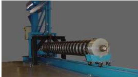
Figure 2. Equipo de RCP de escala reducida S4
