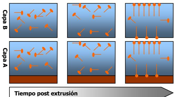
En la representación precedente, las moléculas de deslizante se desplazan hacia las superficies libres de la película, permitiendo que el grupo polar de la molécula de la amida, incompatible con el PE, forme la película deslizante.
