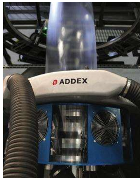
Figura 11. Sistema de enfriamiento ICE de Addex [tomado del boletín técnico: Feria K 2016 – INDESCA].
